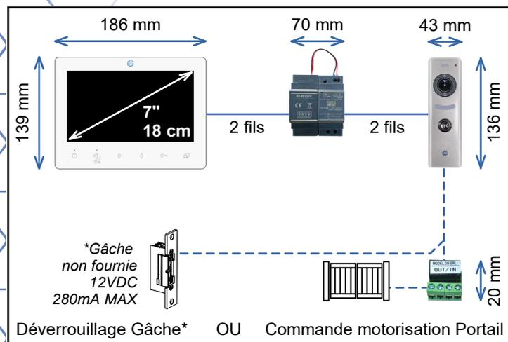
Pour Déverrouillage Gâche ET Commande Automatisme : Mini-RLC-C en option
